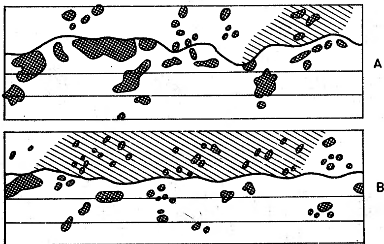
Ryc. 10d. Przemieszczanie wkładki wapna z warstwy 20-25 cm przez pług (A) i pługofrezarkę (B).
