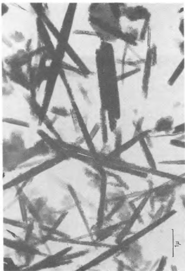
Ryc. 10. Mieszanina kaolinitu i haloizytu (w ile z Unanova): zdjęcie wykonane pod mikroskopem elektronowym transmisyjnym (TEM) firmy Tesla, pow. 5 000 x, autor - V. Sirovy (VURV, Praha-Ruzyně)
