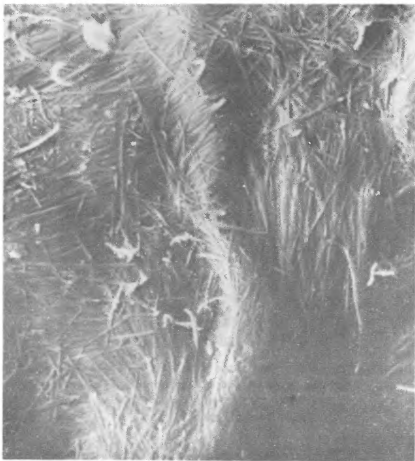
Ryc. 11. Pałygorskit z Zagros (Irak); zdjęcie wykonane pod mikroskopem elektronowym analizującym (SEM) firmy Stereoscan, pow. 10 400 x, próbka pozłacana, autor - Vaněk (VUM, Praha-Zbraslav)
