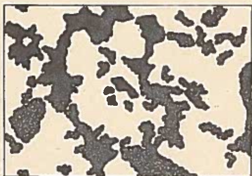
Rys. 32. Obraz przekroju gleby niezagęszczonej (ciemnym kolorem zaznaczone są pory glebowe)
