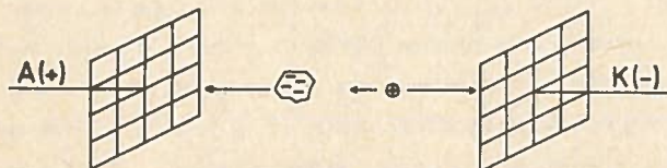
Rys. 9. Schemat oddziaływania ładunku cząstek glebowych na kationy w suspensji glebowej umieszczonej w zewnętrznym polu elektrycznym
