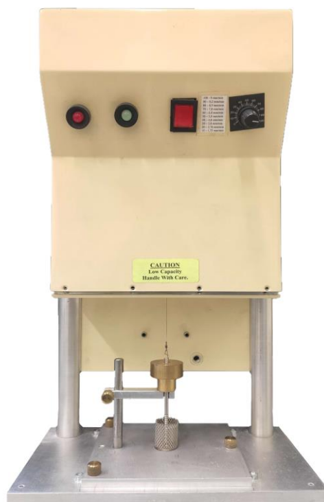
Rys. 5. Stanowisko do badania stopnia zbrylenia i wytrzymałości skonsolidowanych materiałów proszkowych.
