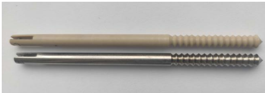
Rys. 6. Iglice pomiarowe wykonane ze stali nierdzewnej i tworzywa sztucznego, o głębokości nacięć 0,65 mm.
