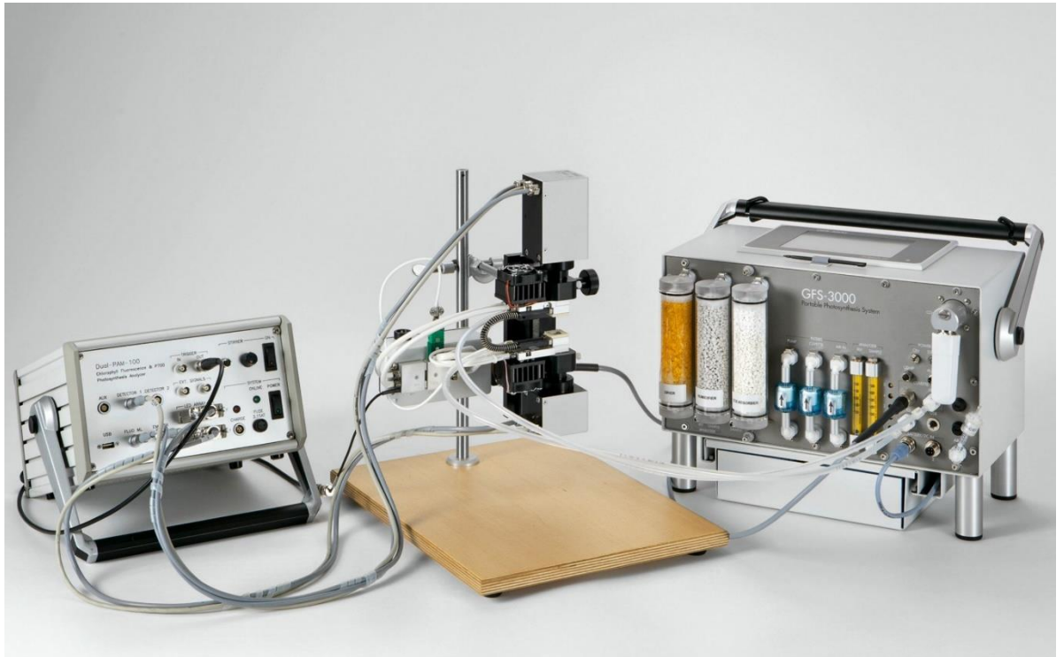
Rysunek 6 Zestaw pomiarowy DualPAM 100 i GFS-300 do pomiaru intensywności fotosyntezy
