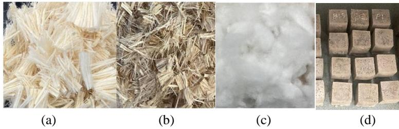
Fig. 1. (a) PALF (b) BF (c)RPET (d) Sample FRC 5x5x5mm
