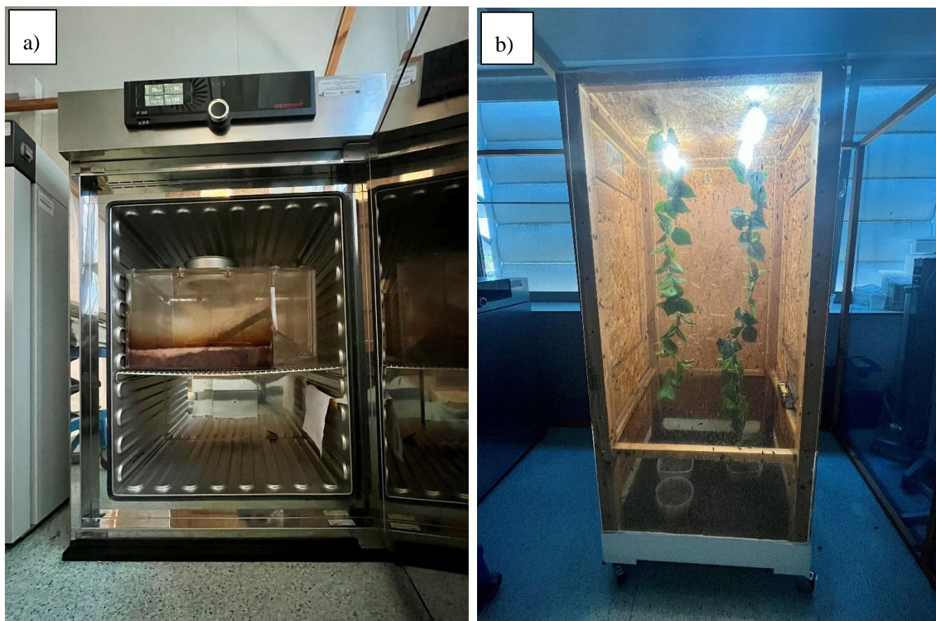
Rys. 3. a) Larwarium i b) insektarium do hodowli owada H. illucens w Instytucie Agrofizyki Polskiej Akademii Nauk w Lublinie.
