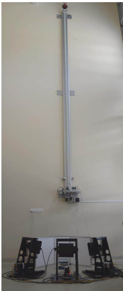
Rys. 5. Winda służąca do modyfikacji wysokości swobodnego spadku kropli (Foto: zdjęcie własne).
